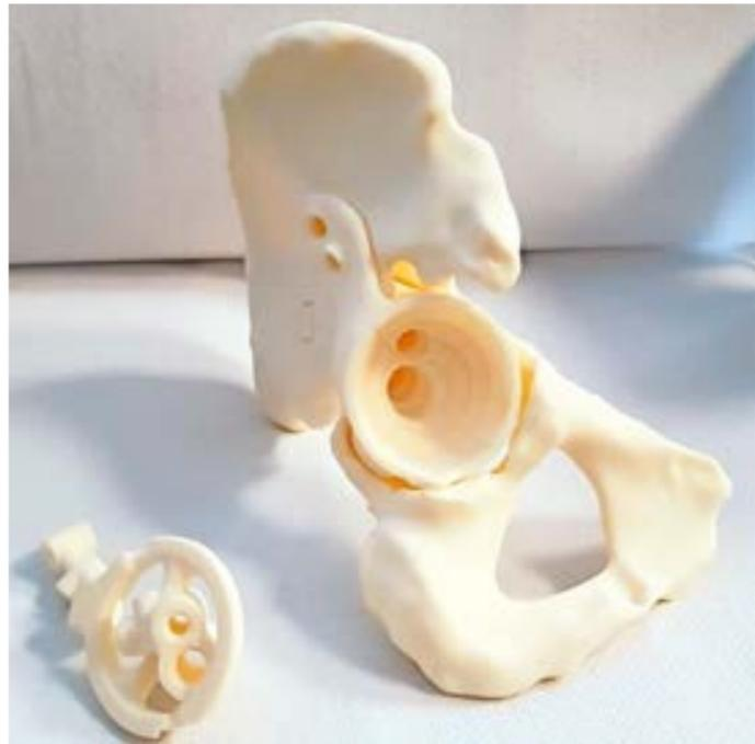
Das Implantat, das sowohl den medizinischen als auch allen technischen Ansprüchen genügt. Das erstellte Implantatmodell wird dann im 3D-Drucker gefertigt: Ein Elektronenstrahl schmilzt lagenweise aufgetragenes Titanpulver und baut so Schicht für Schicht das gewünschte Modell hochpräzise nach. Nach Beschichtung, Nachbearbeitung und Sterilisation wird das Sonderimplantat dann eingesetzt.
